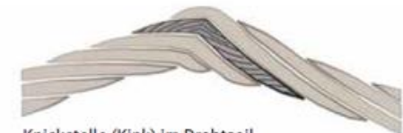
Knickstelle (Kink) im Drahtseil Kink in de kabel Kink in the wire
