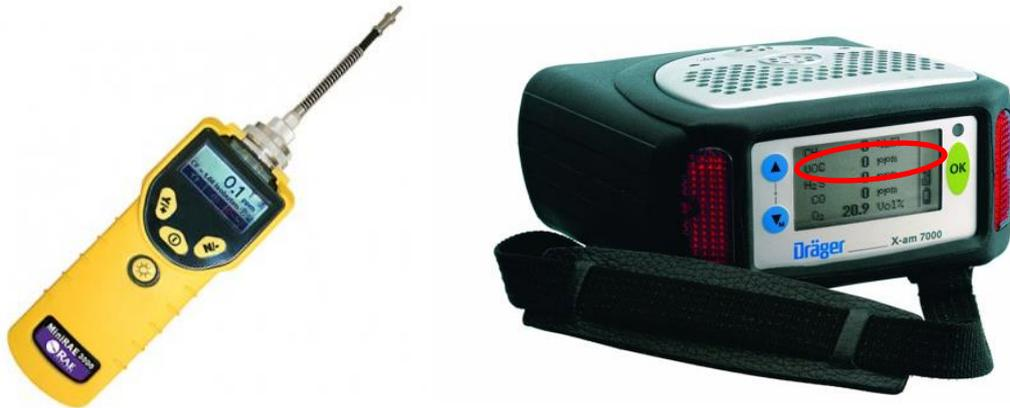
Ein PID-Messgerät erfasst kontinuierlich die bestehenden Konzentrationen flüchtiger organischer Bestandteile (VOC), toxischer Gase und/oder Dämpfe, ausgedrückt in Parts per Million (PPM). Ein PID-Messgerät erfasst jedoch keinen Stoff spezifisch, alle VOC in der zu messenden Gasprobe werden als ein gemeinsamer Wert auf der Anzeige des PID-Detektors wiedergegeben.
