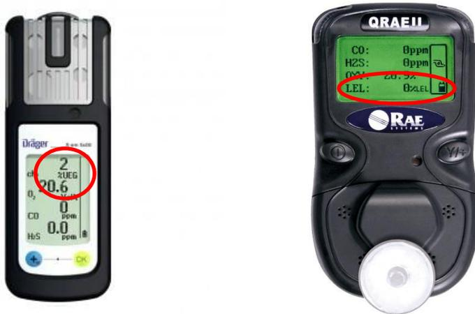
Bei einer Konzentration von mehr als 10-20 % LEL wird ein akustischer und optischer Alarm gegeben. Wenn 100 % der unteren Explosionsgrenze gemessen werden, bedeutet dies, dass das Gemisch entzündlich ist. Für eine solche Entzündung reicht dann eine Zündquelle mit hinreichender Energie.
